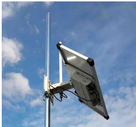
La pasarela 4G solar para exteriores recibe mensajes LoRa de los sensores FireFly y envía los datos a través de Internet a la base de datos. Una sola pasarela es suficiente para procesar los datos procedentes de hasta 100 FireFlies. Adecuada para su uso en exteriores, esta pasarela GoutSolar se conecta a través de una conexión 4G y/o un cable Ethernet. La pasarela puede conectarse a la red eléctrica, pero también cuenta con un panel solar y una batería para funcionar sin conexión a la red.
