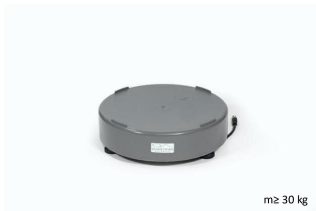
La báscula vertical se puede utilizar para pesar macetas medianas y grandes, como apoyo al riego y/o a la determinación de la biomasa. La báscula está disponible en versión cuadrada o redonda, con un rango de medición de 3, 6, 10, 30, 60 o 90 kg. La báscula está conectado a un FireFly y puede tararse reiniciando el FireFly de forma inalámbrica.
