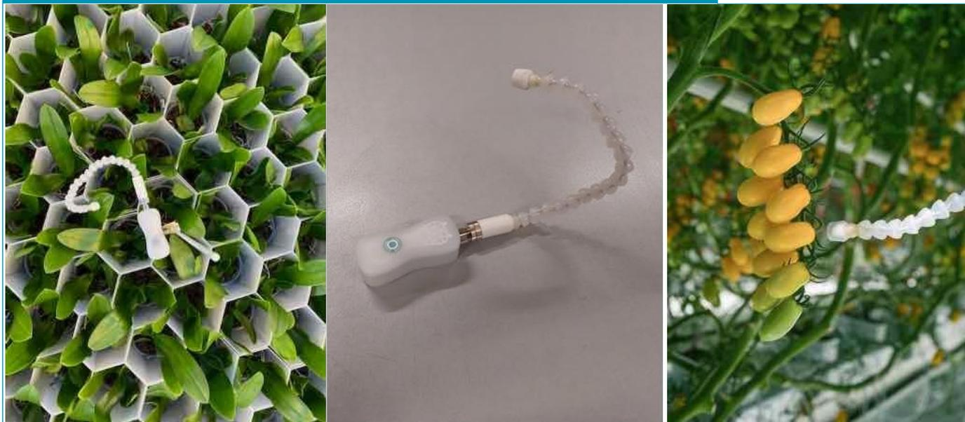
El termómetro de infrarrojos permite medir sin contacto la temperatura de la superficie de, por ejemplo, hojas o frutos. El sensor se utiliza para detectar el estrés de las plantas (VPD).
