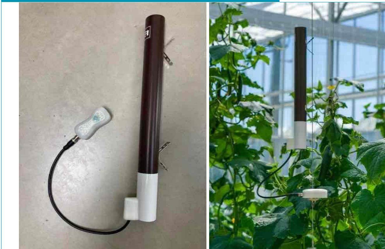
La Chimenea Solar está diseñada para mediciones de temperatura y humedad relativa en presencia de alta radiación (solar). La radiación genera un flujo de aire natural a través de la chimenea, lo que permite ventilar la temperatura y la humedad relativa del aire. El sensor de la plataforma FireFly se conecta a través del cable conector y proporciona la transmisión de datos. Hay varias opciones de montaje para elegir. Utilice el modelo Solar Chimney SubZero para mediciones bajo 0 °C (bajo pedido).
