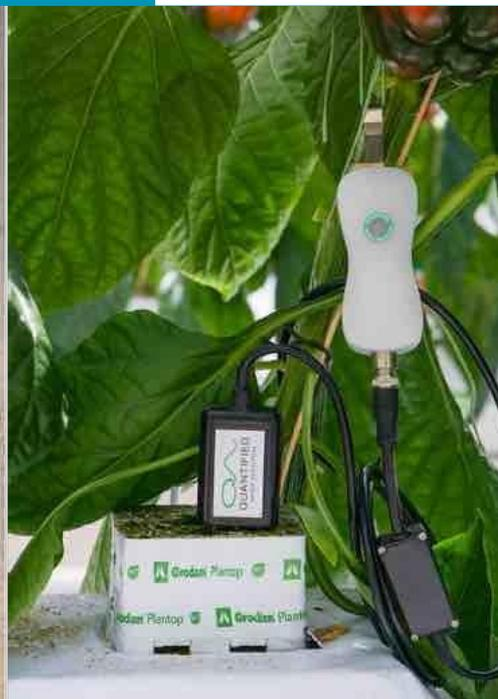
El sensor Poseidon WET mide la permitividad\*, la electro-conductividad (EC) y la temperatura del suelo o sustrato. Hay tres versiones disponibles: con un cabezal de medición simple, doble o triple. El (multi) Poseidon debe ser conectado a un FireFly.
