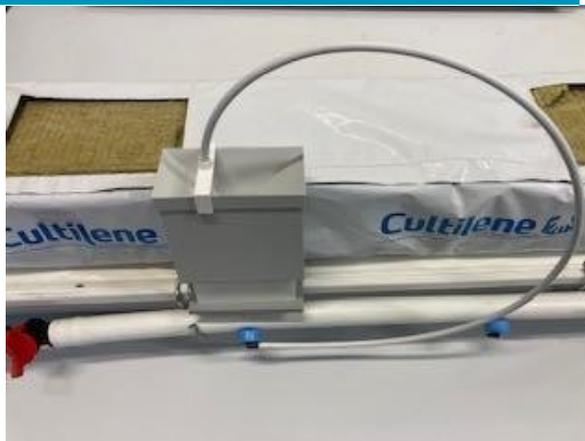
El sensor utiliza la tecnología de cubo basculante (cuchara) y mide: volumen de goteo o drenaje (caudal), CE de drenaje y temperatura de drenaje. El sensor se conecta a un FireFly.
