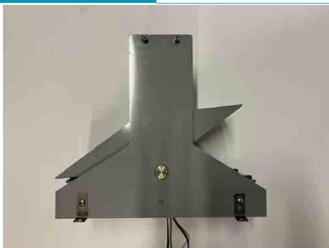
El sensor de drenaje/goteo es un sensor de cubo basculante para medir grandes volúmenes de drenaje. El sensor está conectado a un FireFly.
