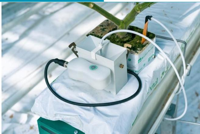
El sensor utiliza la tecnología de cubo basculante (cuchara) y mide el volumen del gotero o desagüe (caudal). El sensor se conecta a un FireFly.
